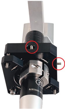
Abb. 5 Schrauben für vertikale und horizontale Verschiebung
