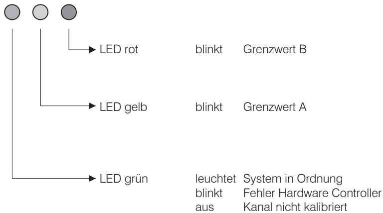
Abb. 6 Funktionalität der LED's an der Vorderseite des Controllers
