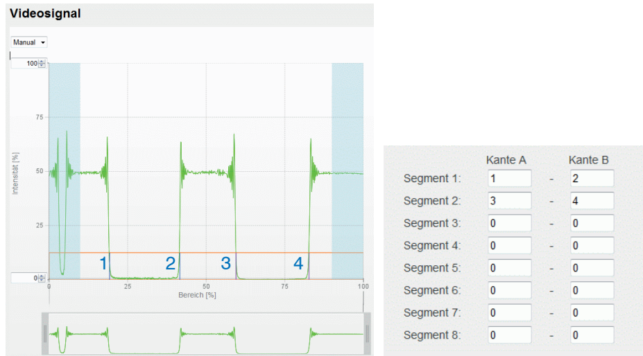
Abb. 33 Videosignal mit definierten Segmenten
